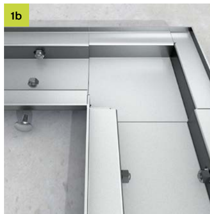
1b Anschließend den L-Verbinder und die Kanalsegmente mit FRSV 6x12 sowie SEMS 6 Muttern verschrauben.
