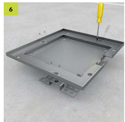
6 Zur Montage der Kassette werden 3 Nivellieranker benötigt. Fixieren mit 2 Senkkopfschrauben UKS M3x6E je Nivellieranker (Positionen siehe Bild).
